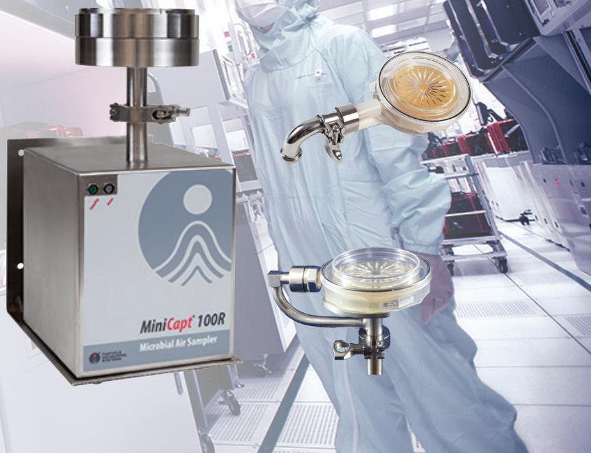
MiniCapt® 远程微生物空气采样器允许用户在各种洁净室环境中进行微生物空气采样，从而实现活粒子污染分类和监测。
